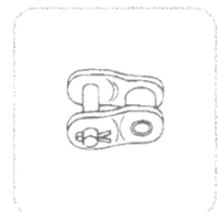
L Gekröpftes Glied mit Splint Offset link
