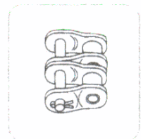
L Gekrüppertes Glied mit Splint Offset link
