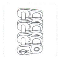
L Gekroftes Glied mit Splint Offset link
