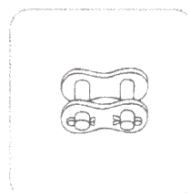
S Verbindungsglied mit Splinten Cotter pin Connecting link
