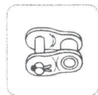
L Gekrüpptes Glied mit Splint Offset link
