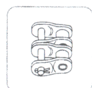
L Gekröpftes Glied mit Splint Offset link
